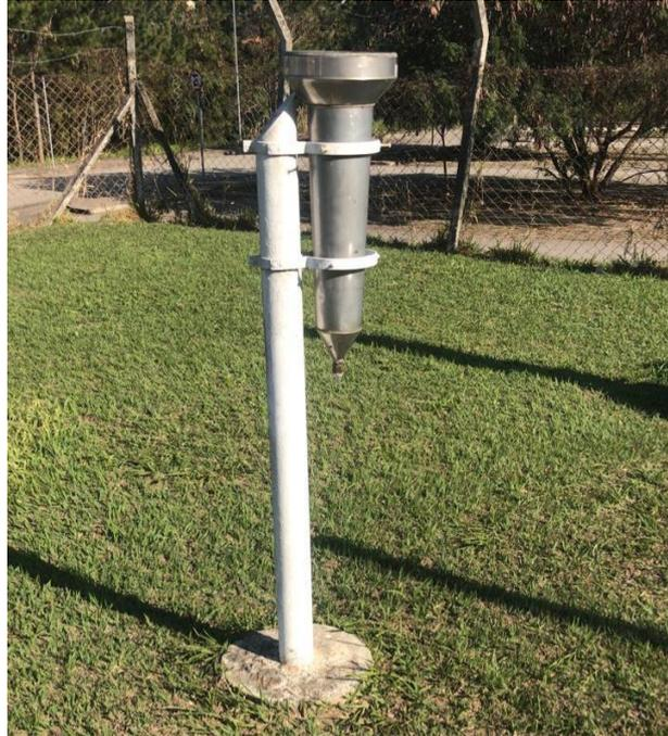
**Figura 3** - Pluviômetro da estação meteorológica convencional do INMET instalado na FATEC Sorocaba.
