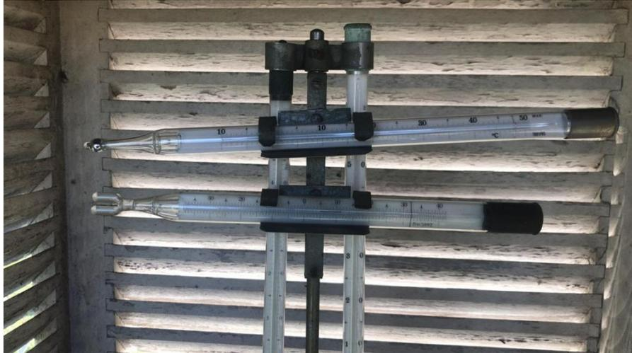
**Figura 5** - Termômetros de máxima e mínima da estação meteorológica convencional do INMET instalado na FATEC Sorocaba.
