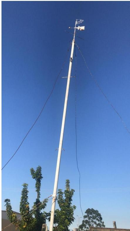
**Figura 4** - Anemômetro da estação meteorológica convencional do INMET instalado na FATEC Sorocaba.
